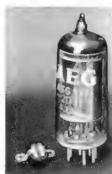
Heizleistung einen Katodenstrom von 0,1 A (max. 0,5 A) verträgt und mit einer Spitzensperrensorgung von 1,3 kV dem im Ausland sehr verbreiteten Typ 2 D 21 entspricht. Bei 220 Volt Wechselspannung beträgt daher ihre Ausgangsleistung etwa 20 Watt. (Wo größere Schaltleistungen benötigt werden, können in Verbindung mit diesem Thyatron oder an seiner Stelle auch größere Typen, z. B. ASG 5017, 5023, 5045, 5055 usw. gewählt werden.)
