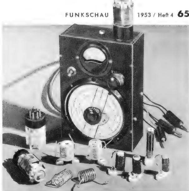
Bild 2. Ein praktisch ausgeführtes Meßgerät mit den zugehörigen Steckspulen (Aufnahme: C. Stumpf)
